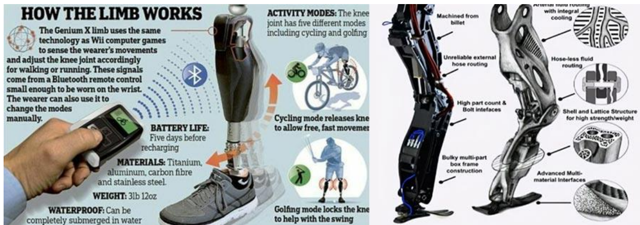
تصویر ۶: نمونه ای از پروتزهای پای میکروپروسور
