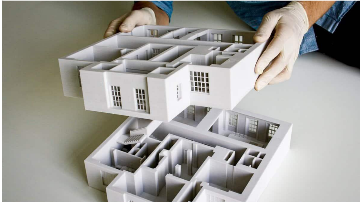
شکل (1) پرینت ماکت با جزئیات توسط پرینتر سه بعدی
