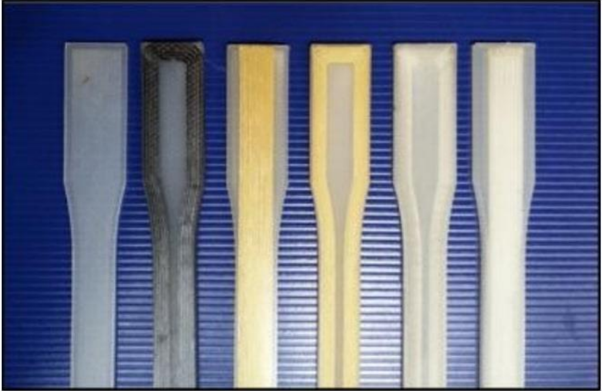
12- نمونه‌هایی از الگوهای تقویت فیبر مورد استفاده در مطالعه. از چپ به راست، نایلون، کربن A، کولار B، کولار A، شیشه A، شیشه B (توجه داشته باشید A الگوی متمرکز و B الگوی ایزوتروپیک است.)
