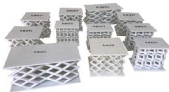
شکل 1 پانلهای مشبک ساخته شده به روش پرینت سه بعدی
