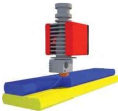
شکل ۷- نحوه ذوب مواد و لایه سازی قطعه در حال پرینت
