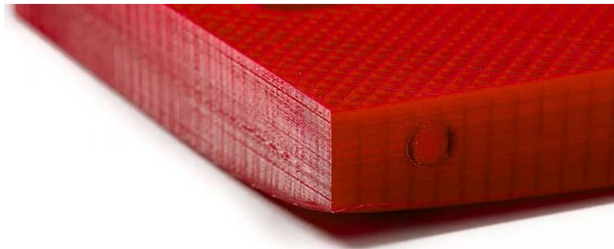
تاب برداشتن قطعه در پرینت سه بعدی
